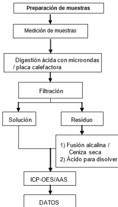
Diagrama de flujo de pruebas de cromo hexavalente (Cr(VI))
